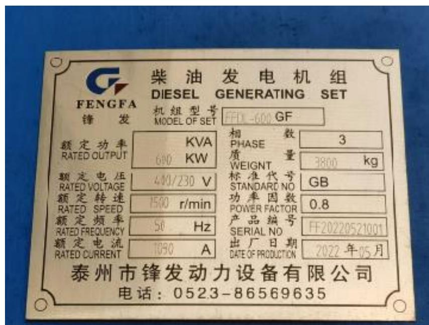
FFDL-600GF 型通信用低压柴油发电机组样品照片
